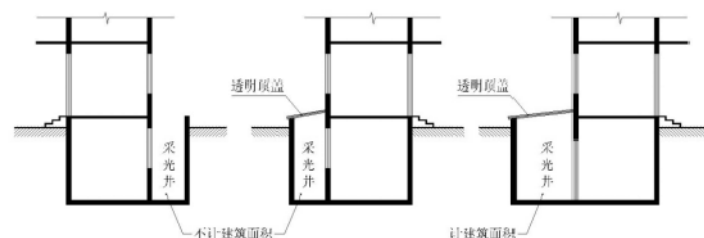
图 2 地下室采光井面积计算图示
