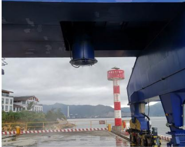
图1 装卸漏斗处采用湿式喷雾和挡风板控制扬尘
